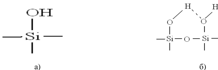
Рис. 4. Активные структурные группы, имеющиеся на поверхности силикагелей: а) силанольная группа; б) вицинальная группа
