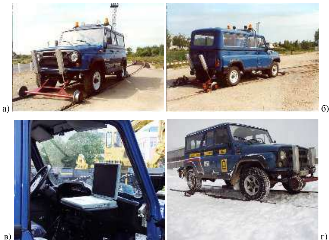
Рис. 2. Дефектоскопная лаборатория на базе автомобилей УАЗ-3153.
