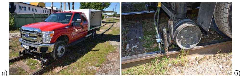
Рис. 5. Рельсосмазочная машина на базе ТКХ Ford F450.
