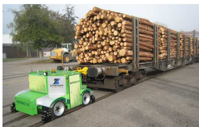
Рисунок 3 – Техника на комбинированном ходу для маневровых работ
