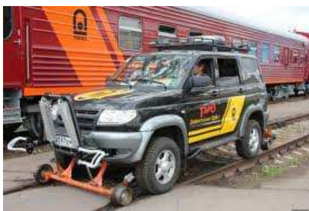
Рисунок 1 – Постановка техники на комбинированном ходу на железнодорожный путь
