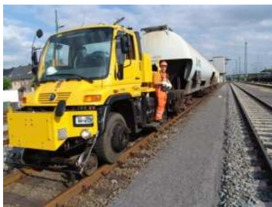
Рисунок 3 – Техника на комбинированном ходу для маневровых работ
