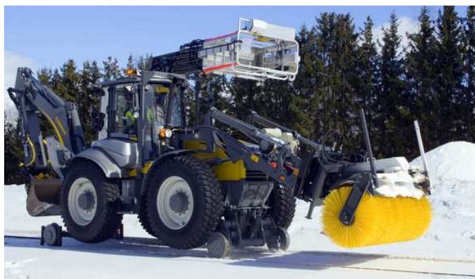
Рисунок 2 – Техника на комбинированном ходу для обслуживания и ремонта железнодорожного пути
